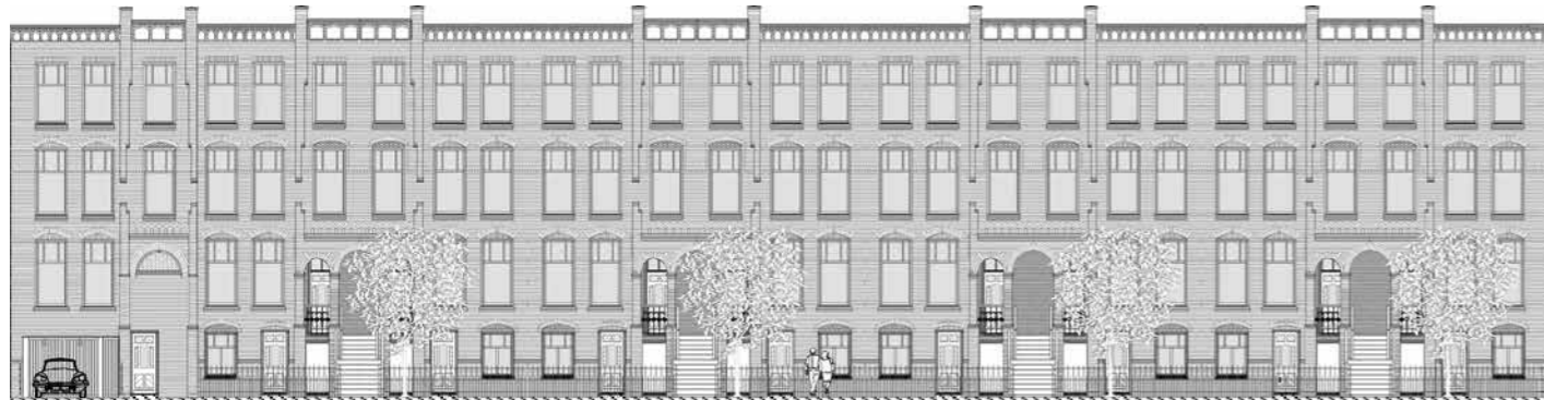
Edificio Norte. Alzado principal. Obrechtstraat
